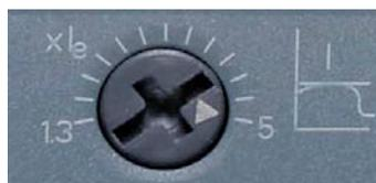
No potenciômetro  $xI_e$ , ajusta-se o valor de limitação de corrente, enquanto fator da corrente nominal do motor ajustada ( $I_e$ ), para a corrente máxima pretendida durante a partida.
