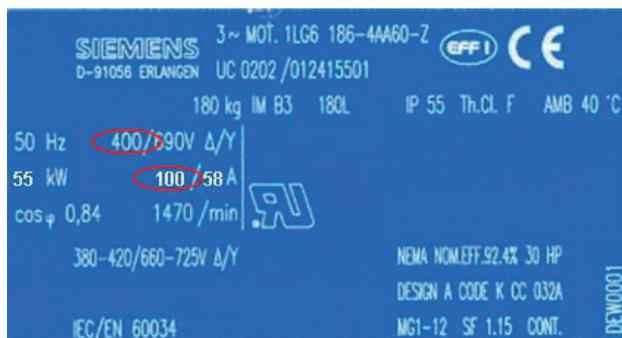
No potenciômetro  $I_e$ , é necessário ajustar a corrente de operação nominal do motor de acordo com a tensão da rede existente ou o circuito do motor (estrela/triângulo). Também a proteção eletrônica contra sobrecarga do motor se refere a este valor ajustado, quando está ativada. Sobre os valores de ajuste admissíveis relativos ao disparador de sobrecarga do motor pretendido, ver o capítulo Valores de ajuste da corrente do motor (Página 117).
