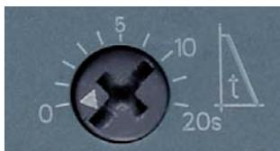
No potenciômetro t, é possível ajustar um tempo de inércia. Deste modo, é possível determinar durante quanto tempo o motor recebe energia após o cancelamento da ordem de ligação. Dentro deste tempo de inércia, o torque gerado no motor é reduzido através de uma função de rampa de tensão e a aplicação é imobilizada suavemente.
