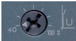
No potenciômetro U, é ajustado o nível da tensão de arranque. O nível da tensão de arranque determina o nível do momento de ligação do motor. Uma tensão de arranque inferior implica um torque inferior (arranque mais suave) e uma corrente de partida inferior.
