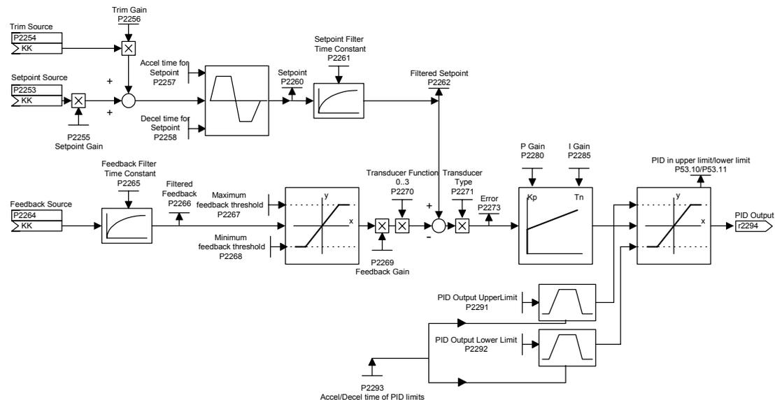
Este parâmetro permite ao usuário selecionar a origem do setpoint do PID. Normalmente um setpoint digital é selecionado utilizando-se um setpoint fixo ou um setpoint ativo.
