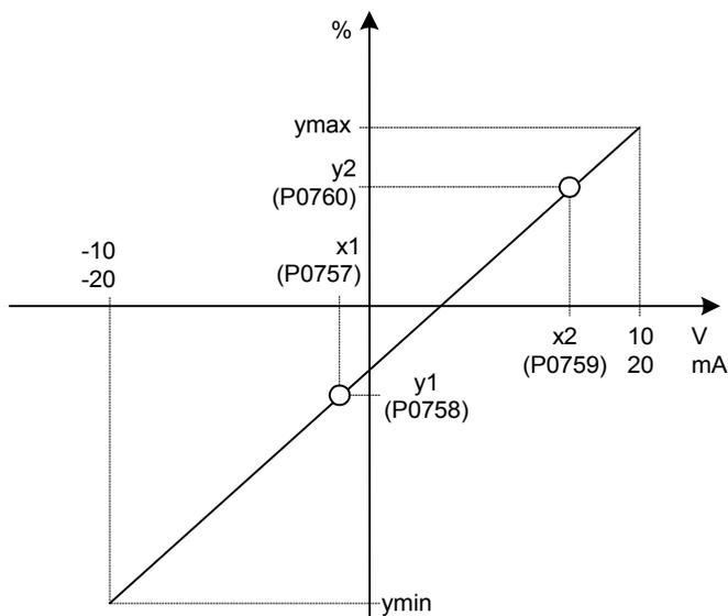
Valor de entrada analógica (ADC) 2 a 10 V (-50 a +50 Hz):
