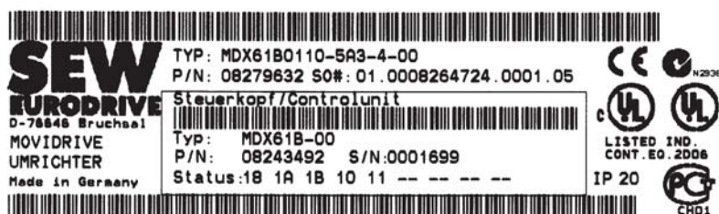
Figura 142: Exemplo: Placa de identificação do sistema para MDX61B.. tamanhos 1 - 6
