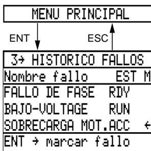
Este modo permite visualizar los últimos fallos (8 como máximo) que se han producido durante el funcionamiento, así como el estado del variador en el momento de producirse los fallos.
